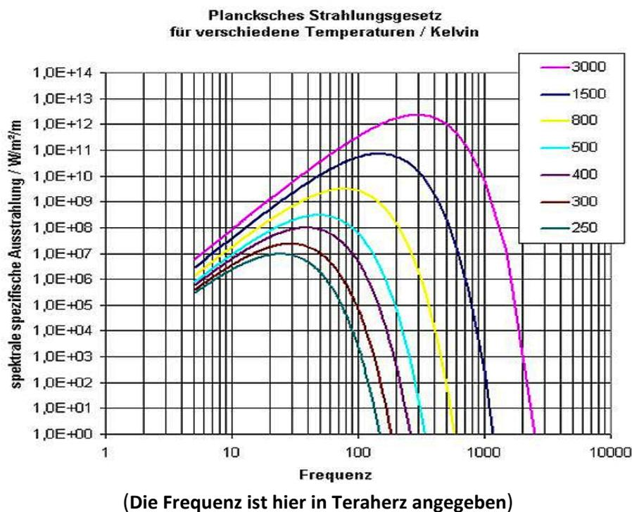
Ein (idealer) schwarzer Körper ist ein Medium, das sämtliche ihn erreichende Strahlung absorbiert (Reflexionskoeffizient=0, Absorptionskoeffizient=1). Dadurch erwärmt sich das Medium. Physikalisch bedeutet dies, dass die Teilchen im Körper oder in der Gaswolke sich immer schneller bewegen. Irgendwann stellt sich ein Gleichgewicht ein, das thermodynamisches Gleichgewicht. Das Objekt nimmt ab jetzt genau so viel Energie auf wie es in Form von elektromagnetischen Wellen abstrahlt.
